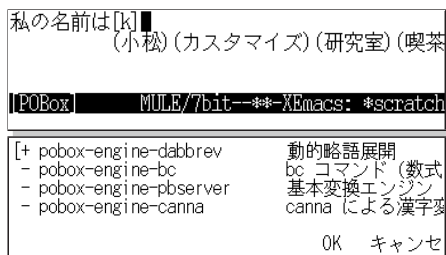
図 7 Emacs 用 POBox (上:動作画面, 下:複数の変換エンジンの選択)
